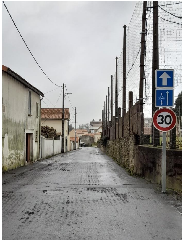
Voie à double sens cyclable, Rue de la Mara, sur une voie étroite ne permettant pas une sécurité optimale des cyclistes (Source : CC de Parthenay-Gâtine)
