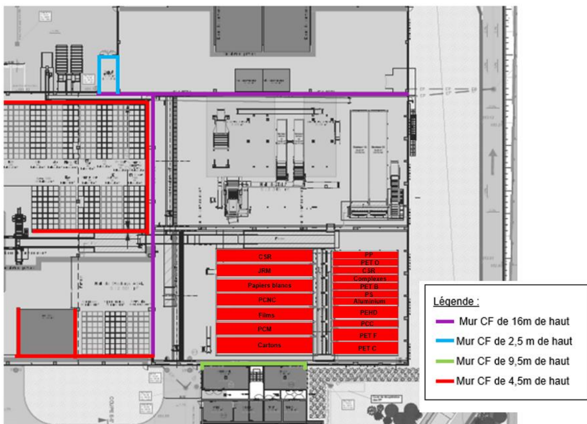
Figure 18 : Localisation des murs coupe-feu du hall de tri du centre de tri – Vue en plan
