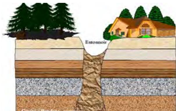
Principe de l'effondrement localisé – Source GEODERIS
